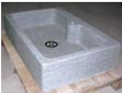
Lavorazione con utensile sagomatore ad asse verticale Vertical shaping tool processing
