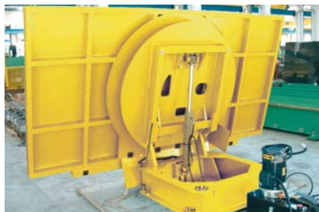
Banco ribaltabile con sistema oleodinamico, rotazione motorizzata e bloccaggio pneumatico in qualsiasi posizione. Bench with oleodinamic tilting system, motorized rotation and pneumatic lock in any position.
