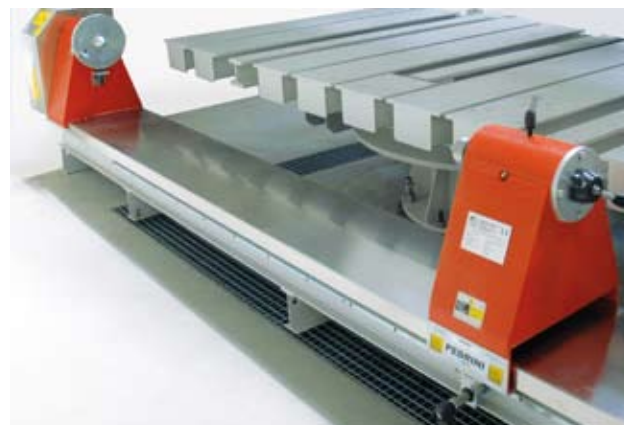
Tornio con divisore e contropunta regolabile. Lathe with indexing unit and adjustable tail stock.
