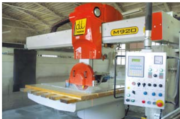
Banco con rotazione motorizzata e bloccaggio pneumatico in qualsiasi posizione. Bench with motorized rotation and pneumatic lock in any position.
