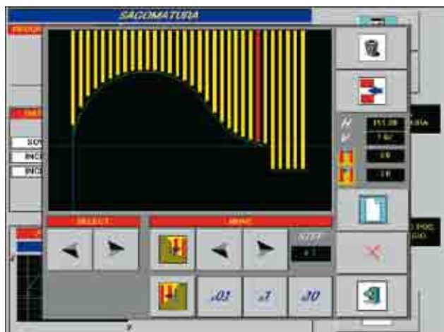
Sagomatura con tagli paralleli (sbancamento). Rough shaping by parallel cuts (scabbling).
